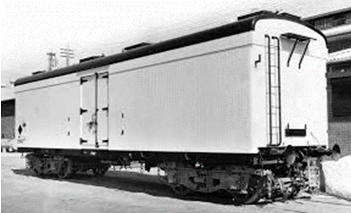
ABOVE: Refrigerator van
